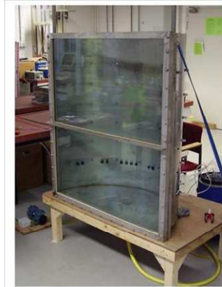
Abbildung 1: Fotos: Ansichten des Versuchsstandes „Wasserinfiltration über Makroporen“; links leer, rechts mit 110 cm hoher Sandfüllung in der „Halbtonne“; Schema rechts: Anordnung der 24 Tensiometer (-Messpunkte) zur Bestimmung des Porenwasserdrucks (oben Aufsicht, unten Ansicht (Tensiometer auf Scheibe projiziert)).
