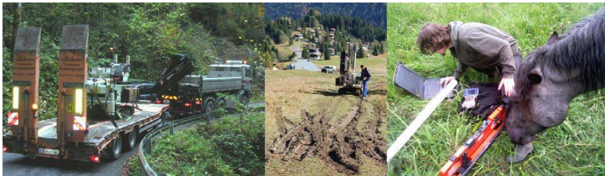
Abbildung 1: Transport der DP-Sondiermaschine nach Ebnit (links), rutschiger Untergrund verhindert Sondierungen in höheren Hangbereichen (Mitte) und EM-Kartierung zwischen Tieren (rechts).
