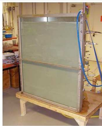
Abbildung 1: Fotos: Ansichten des Versuchsstandes „Wasserinfiltration über Makroporen“; links leer, rechts mit 110 cm hoher Sandfüllung in der „Halbtonne“; Schema rechts: Anordnung der 24 Tensiometer (-Messpunkte) zur Bestimmung des Porenwasserdrucks (oben Aufsicht, unten Ansicht (Tensiometer auf Scheibe projiziert)).
